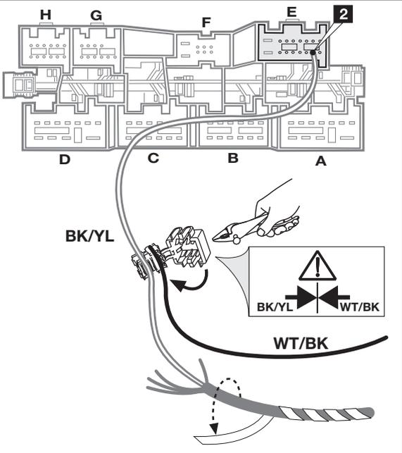
Bordnetzsteuergerät Position "E"
